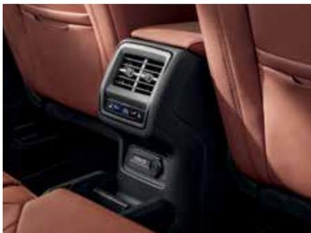
Трехзонный автоматический климат-контроль, отдельно регулируемый для водителя, переднего и задних пассажиров.
