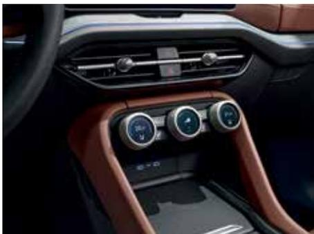
Smart Dials - три многофункциональные кнопки обеспечивают быстрый доступ к широкому спектру функций автомобиля.
